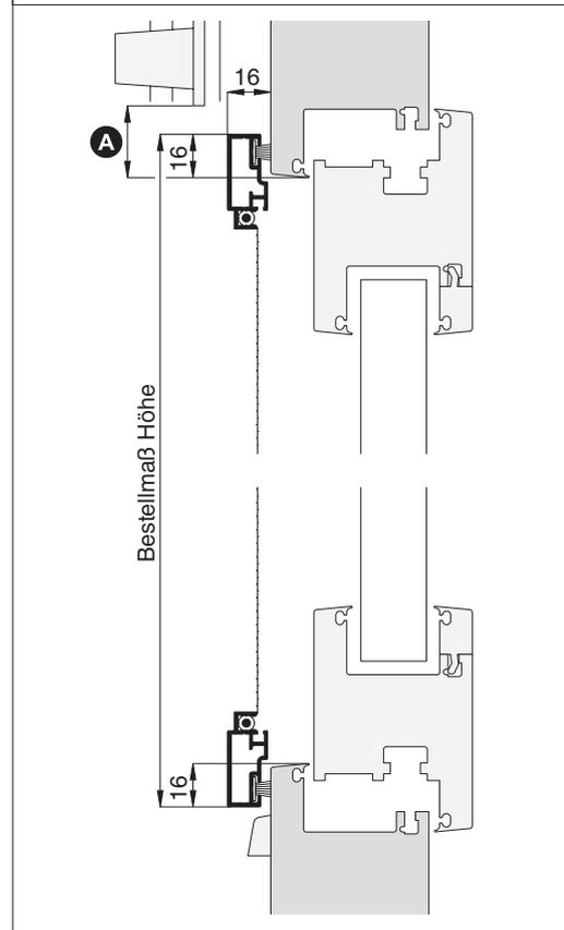
**Bei sehr schrägem Blendrahmenüberschlag (> 5 mm) anderen Messpunkt verwenden:**
