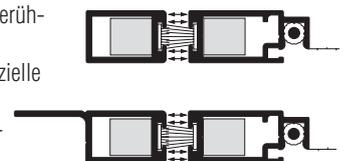
Bei extremen Windbelastungen kann die Magnetkraft durch Einhängen weiterer Blockmagnete verstärkt werden (Zusatzausstattungen, Seite 12).
