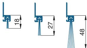
Über ein Langloch kann das h-Profil 10 35 61 bis zu 6,5 mm ausgeglichen werden.
