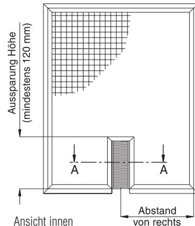
Die Aussparungen für die automatischen Fensteröffner werden über ein h-Profil mit Streifenbürste abgedichtet. Es stehen dabei 2 verschiedene Größen zur Verfügung.
