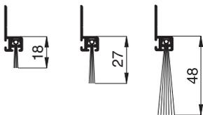
Über ein Langloch kann das h-Profil 10 35 61 bis zu 6,5 mm ausgeglichen werden.
